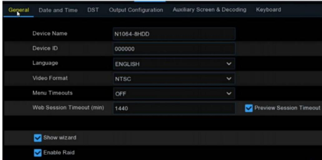
Remarque : Une fois la fonction RAID activée, le NVR ne prend pas en charge ESATA et NAS.
