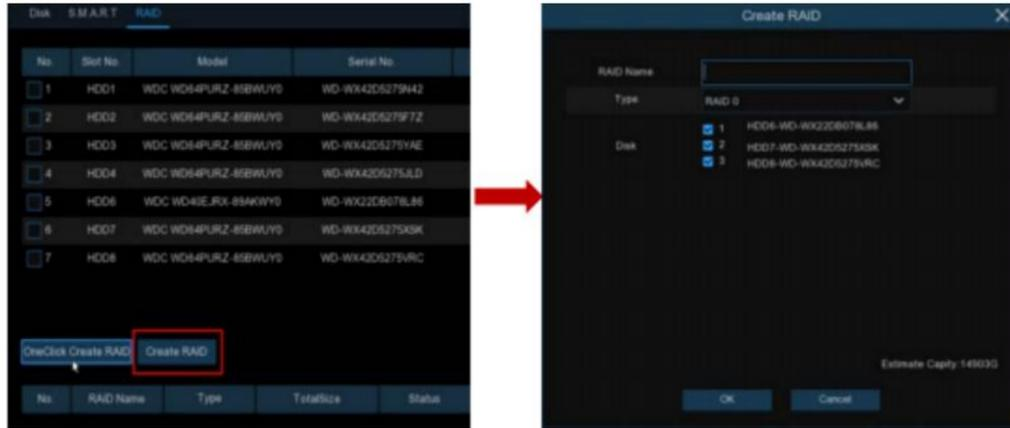
Pour activer le RAID pour une utilisation normale, vous devez d'abord formater le RAID. Une fois le formatage RAID terminé, ouvrez la page de configuration du groupe de disques, sélectionnez le groupe de disques et les canaux d'enregistrement, et assurez-vous que l'enregistrement de la caméra est normal.
