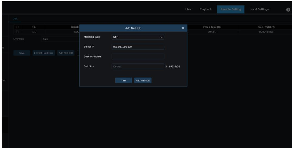
**Type de montage** : Il existe deux types de montage : NFS, SMB/CIFS. NFS ne nécessite pas le nom d'utilisateur et le mot de passe du NAS, mais SMB/CIFS nécessite de telles informations.
