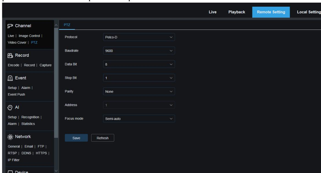
**Protocole** : Il existe deux options : **PELCO-D** et **PELCO-P** . Le contenu du protocole comprend des commandes de contrôle PTZ, des commandes de contrôle de caméra PTZ et des commandes de contrôle auxiliaires. La transmission RS-485 est généralement utilisée. Pour la caméra PTZ, ce paramètre est fixé de manière fixe sur **PELCO-D** .
