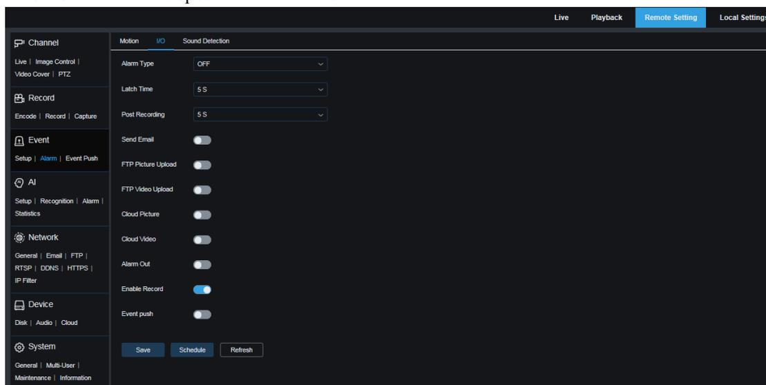
**Type d'alarme :** Il existe trois options : **Normalement ouverte** , **Normalement fermée** et **OFF** . Sélectionnez un type qui correspond au type de capteur ou sélectionnez OFF pour désactiver la fonction de déclenchement du capteur.
