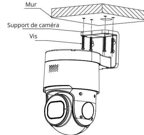
Étape 3 : Alignez le support de la caméra avec les 4 trous de vis des particules colloïdales gonflantes, et verrouillez les vis pour les fixer.
