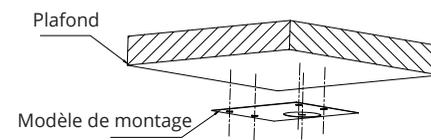
Étape 1 : Coller le gabarit de montage sur le mur, percer 4 trous de vis et 1 trou pour le câble d'alimentation.
