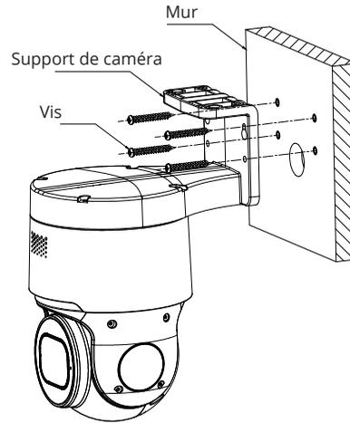
Étape 3 : Aligner le support de la caméra sur les 4 trous de vis des particules colloïdales gonflantes et verrouiller les vis pour les fixer.
