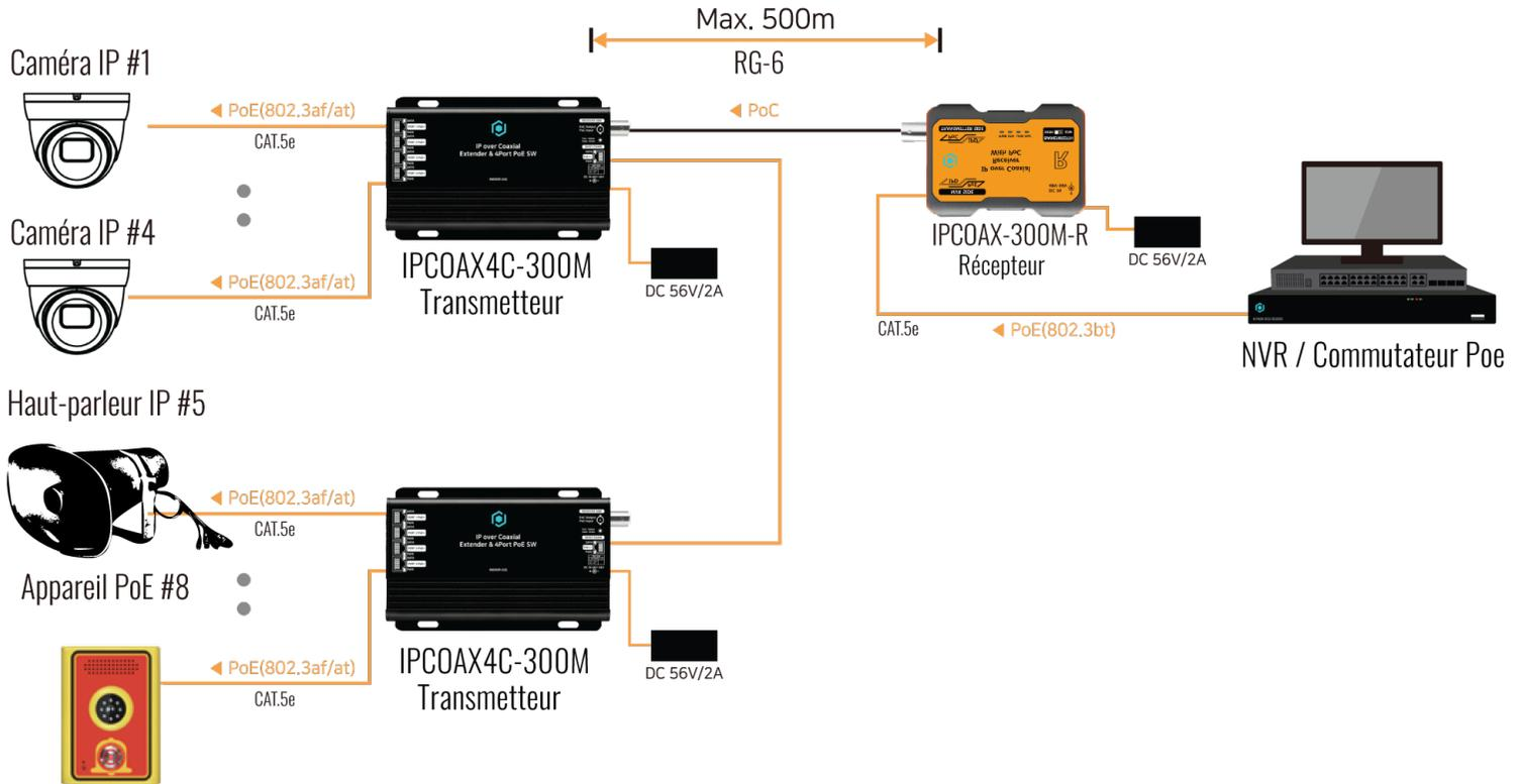
En cas de connexion avec un commutateur 802.3bt (ou un injecteur PoE 802.3bt)
