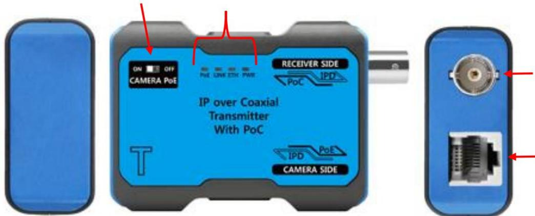
CAMÉRA PoE : commutateur pour régler l'alimentation de la caméra IP PoE.
