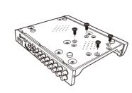
a) Connectez les câbles de données et d'alimentation au disque dur et placez le disque dur sur le boîtier du DVR.
