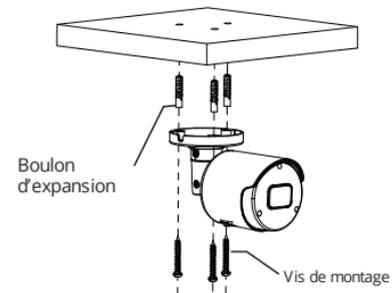
Insérez trois boulons d'expansion en place dans le plafond et fixez l'équipement avec trois vis de montage.
