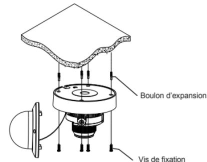
Utilisez la position indiquée sur l'autocollant de position pour percer les trous nécessaires au montage de la base de la caméra. Insérez le boulon d'expansion dans les trous. Faites correspondre les ouvertures de montage de la base à la position des boulons d'expansion, puis placez les vis de montage à travers l'ouverture de montage de la base dans le boulon d'expansion. Serrez les vis de montage pour vous assurer que la base de la caméra est correctement montée.
