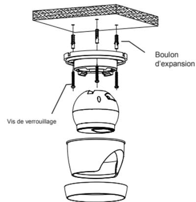
Fixez le piédestal en perçant des trous de verrouillage autour de l'autocollant et en insérant trois boulons d'expansion dans les trous et en le fixant avec trois vis de verrouillage.
